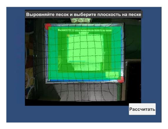
Активируем кнопку Рассчитать. Кнопка становится красной на момент расчета плоскости, после небольшого ожидания кнопка станет зеленой, что значит расчет произведен.
