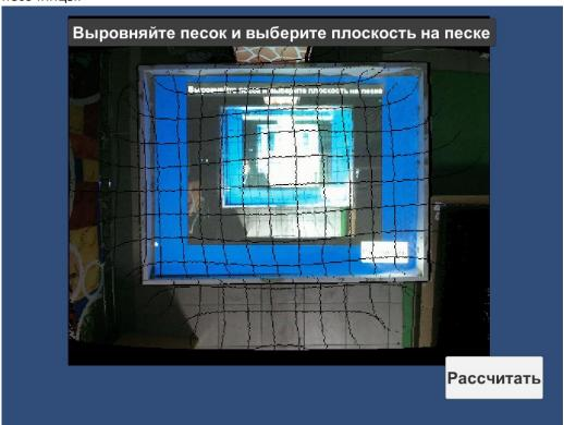
5. Управляя мышкой ставим две точки на плоскости именно самого песка. Сначала отмечаем угловую точку с одной стороны, затем отмечаем вторую точку в противоположной стороне.
